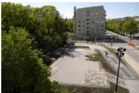
KUVA 2. Ekoluoto-puisto Turussa Wäinö Aaltosen museo, entinen parkkipaikka, sepelireunukset (harmaa karkea sepeli 32-56 mm) puiston ja ajoluiskan reuna-alueilla toimivat hulevesien imeytysojina ja valumien hidastajina.
